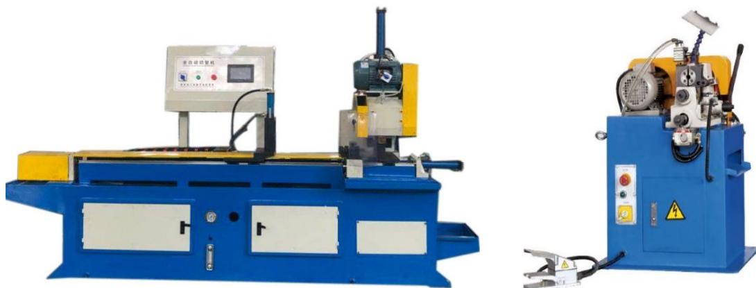
Hình 1.3 Máy cắt tự động và bán tự động chuyên dụng sử dụng tại cơ sở.
