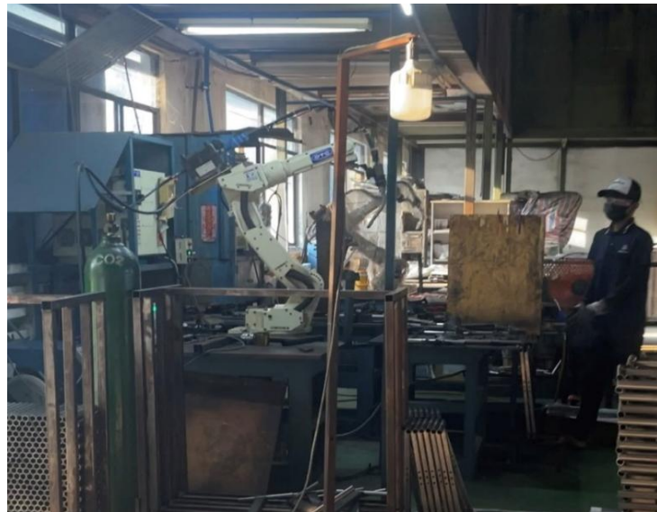
Hình 1.5 Công đoạn hàn tại nhà máy.
